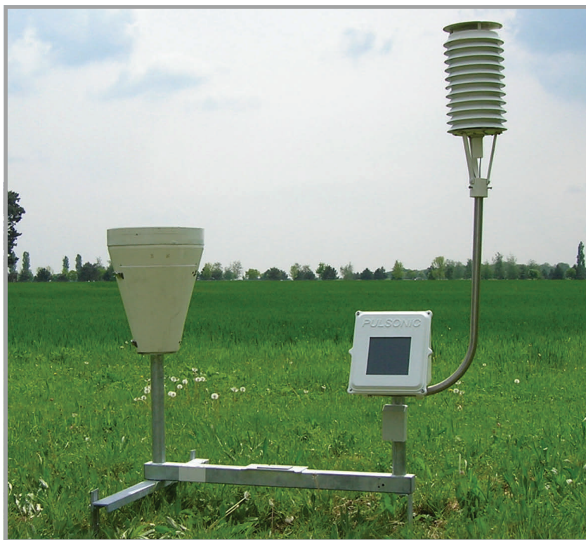
Station PULSIA III avec alimentation solaire
